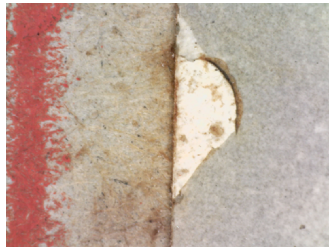
Detalhe de pigmento e perda de emulsão de fotografia_Dinolite 5MP_ampliação x60
